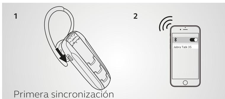
1. Deslice el interruptor Encendido/Apagado hasta la posición de encendido. El LED de estado parpadeará en azul.
